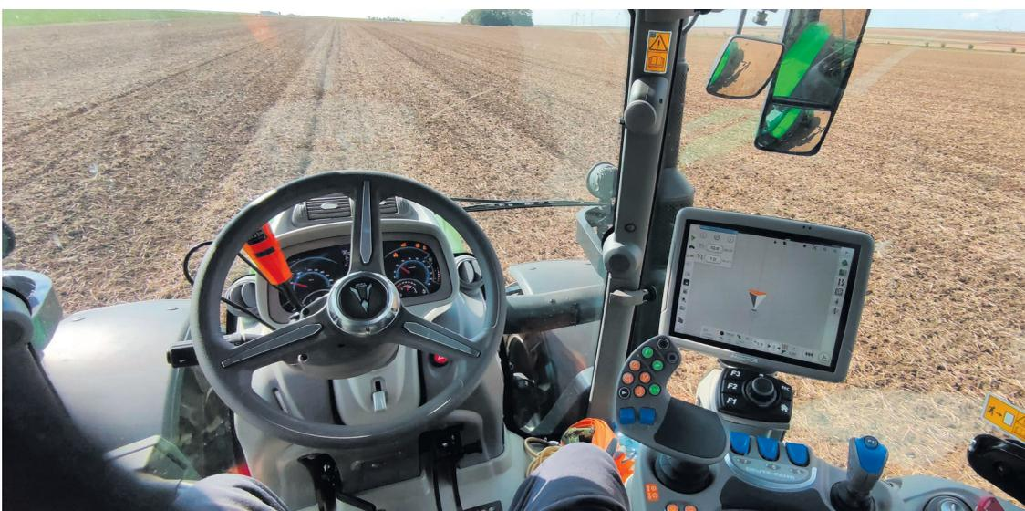
Ein komfortabler Arbeitsplatz: Die Sicht seitwärts wird durch das verdickte Auspuffrohr kaum behindert.
